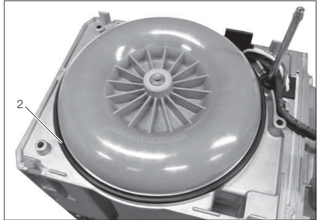
2 O-rengas, asetettuna ohjainlaitteeseen/puhallinyksikköön
